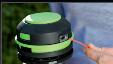
SCHRITT 1 Faden einfädeln.
